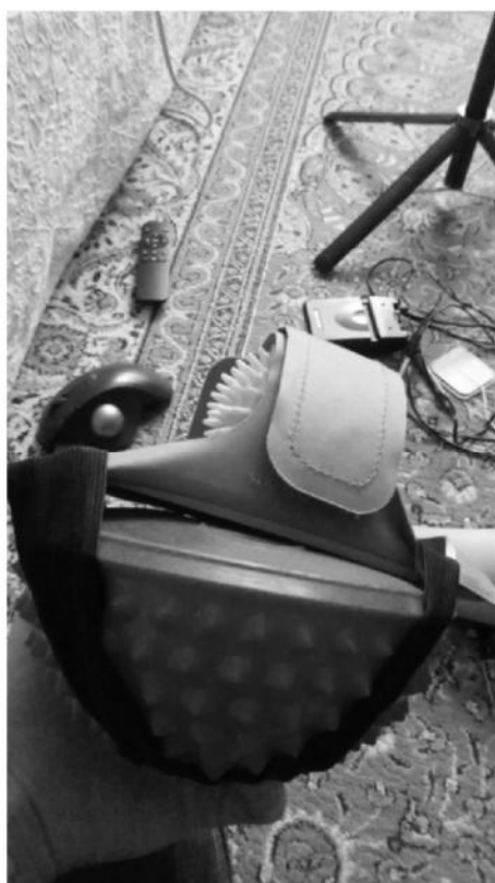
Рисунок 3.4 — Крепление смартфона в чехле на полусфере.
