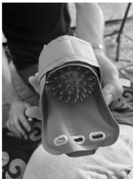
Рисунок 3.3 — Крепление смартфона в чехле на мяче.
